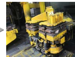
Formen der Kästen auf der Formanlage bzw. Handformen und anschließende Abguss
