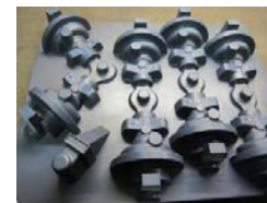
Herstellung der Modelplatten anhand CAD-Daten und Simulationsergebnis
